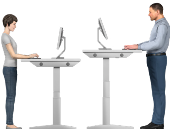
Abb. 2 Verstellbereiche eines Sitz-Steharbeitsplatzes
