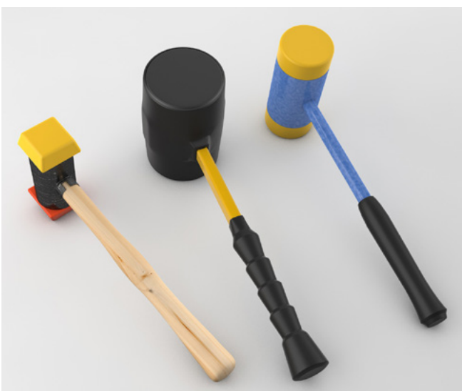
Abb. 26 Rückschlagfreie Hämmer reduzieren die Belastung des Hand-Arm-Systems
